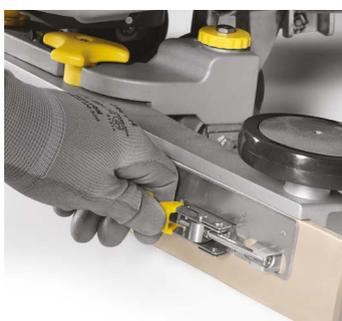
La sostituzione e la rotazione delle gomme del tergilavaggio si realizzano in pochi istanti e non è necessario l'utilizzo di utensili
